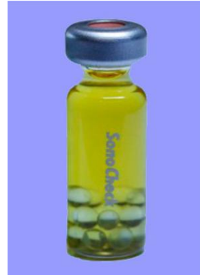
รูป 4 SonoCheck หลังการทดสอบในเครื่อง อัลตราโซนิกที่ทำงานปกติ (ผลเป็นบวก)
